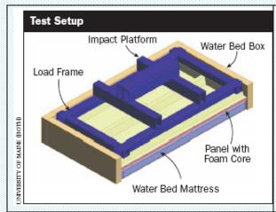
渲染器安装在中心结构性测试实验室的地下室内,这里,复合材料面板可以经受从不同高度下降至 6.1 米高度时重物的重量。注意储水泡;设计夹具是用来模拟船体在高速下空降和击水时发生了什么。
