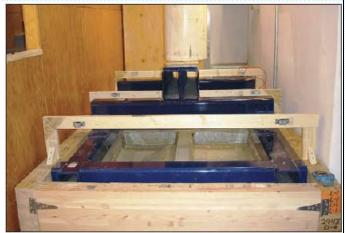
装置如图之建造。一个 90.7kg 重的东西掉到一个集中测试框架的导管上。 大口径的 PVC 管道上钻有通风孔,用以减少压缩空气阻碍重量下降的可能性。测试平台 是用来检测记录加速度和面板扰度的。
