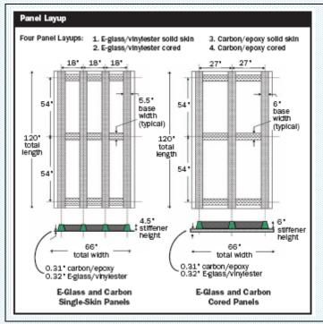
示意图详尽的展示了为了找到一个具有最满意轻质标准和良好冲击吸收性的结构性层压板,中心测试了四个主要型号的船体面板配置。
