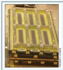
候选的复合材料船体面板(看图),由 Hodgdon 船厂建造船员制造,在先进的结构和 复合材料中心等待结构测试。进行的测试程序 证明在确定特殊作战艇最优层压板时它是不可 缺少的。
