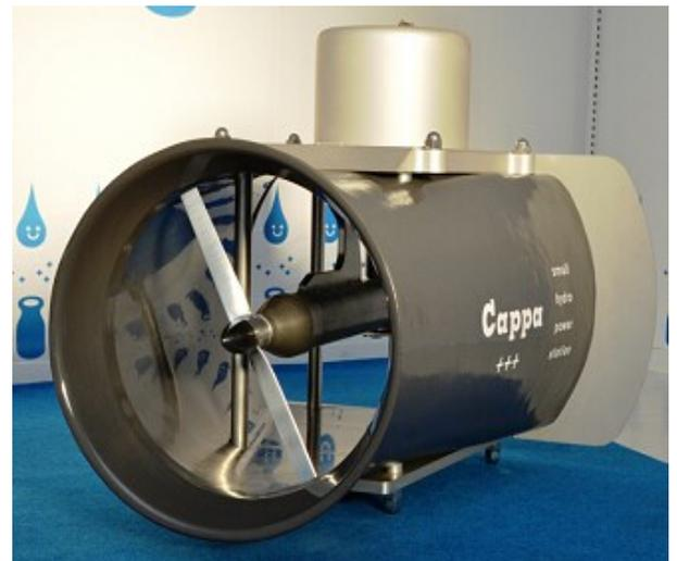
CAPPA的发电机部的尺寸约为832毫米，内圈约长770毫米，高665毫米，重量约57公斤。在水路能达到1.1~4.5米宽、水深50厘米以上、水流速度约1.5~2米/秒的条件下，CAPPA发电机能够无需重机械类辅助，由两个工人人力完成安装，极为方便简洁，在工程应用上具有优势。
