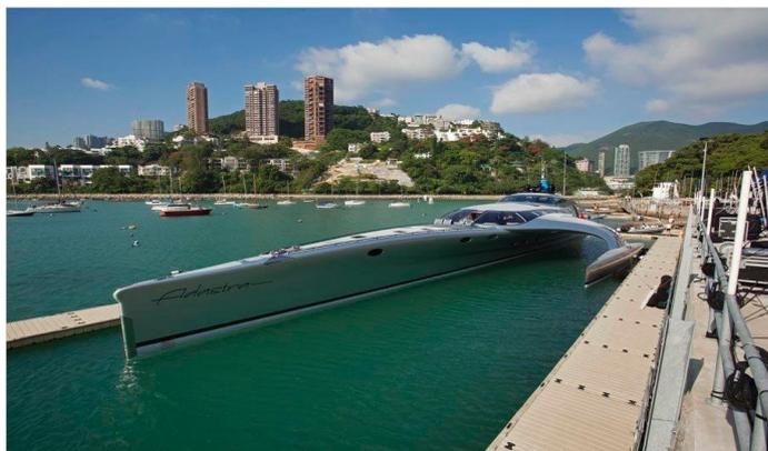
该游艇主体由航天材料碳纤维和防弹纤维建造，采用高度智能化设计，可在50米范围内用一部苹果iPad进行控制。它的“双翼”外形并非只是“花瓶”，它还可用来辅助船身的稳定，并借助航空力学让船速度变得更快，更节能，最大速度达每小时22.5海里（41.67公里），并能以每小时17海里（31.48公里）的速度航行4000海里（7408公里），加满10次油便足够环游世界一周。（来源羊城晚报）
